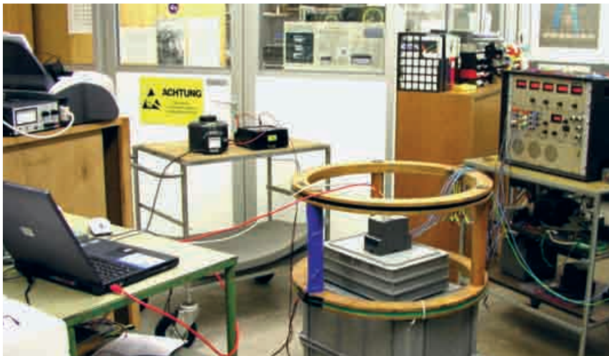
Het bepalen van wat er met een omvormer gebeurt als die m.b.v. een Helmholtzspoel aan een magnetisch veld wordt blootgesteld.
